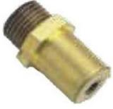
ER390 DIFFUSEUR POUR FOGGY 3 JET 90° • crée une diffusion de courte portée dans 3 directions différentes ; divise le jet dans 2 directions inclinées (une à 30° et l'autre à 120°) et 1 droite (90°). • Ce type de buse permet l'installation du Foggy tout en créant un effet "rideau" dans le cas (par exemple) de protection de surfaces vitrées
